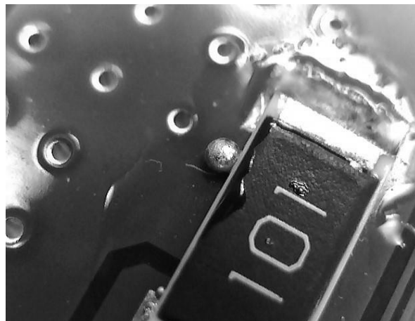
Obr. 52 Kulička vedle součástky [13]
