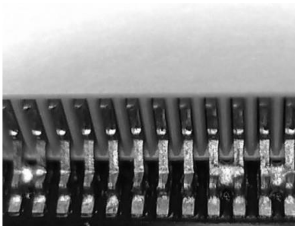
Obr. 49 Zkrat nožiček součástky [13]
