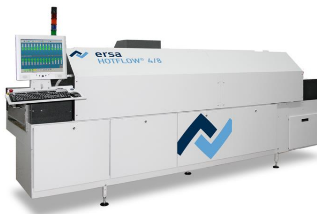
Obr. 13 Pec pro přetavení horkým plynem [14]
