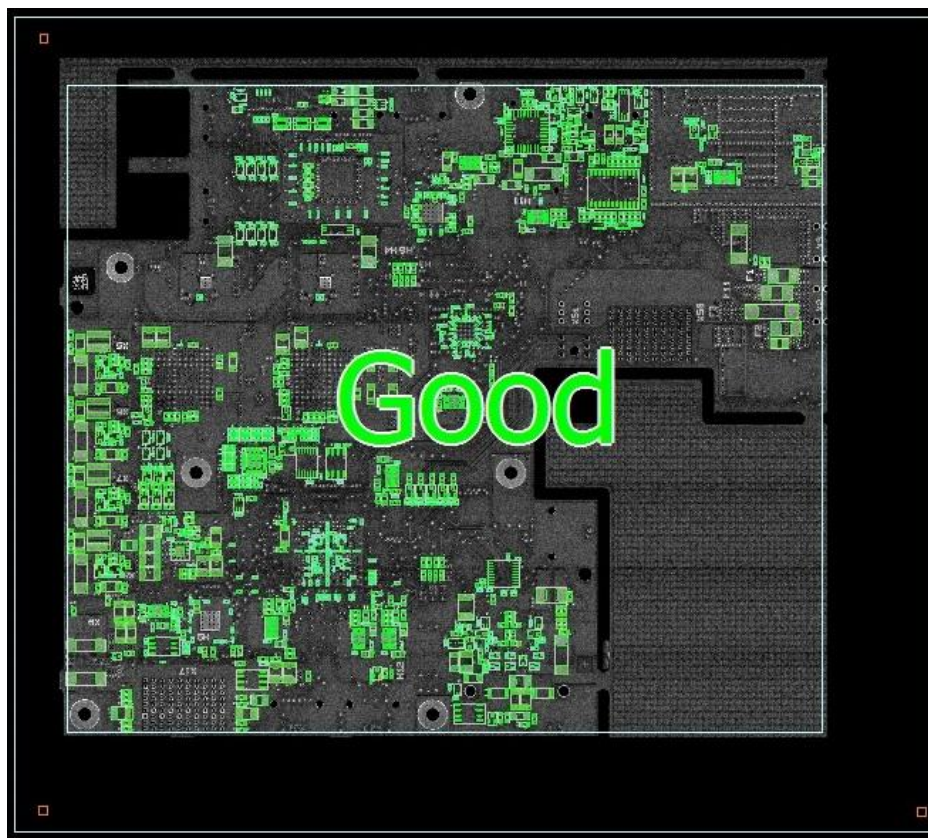
Obr. 25 SPI (nanášeno správné množství pájecí pasty) [12]
