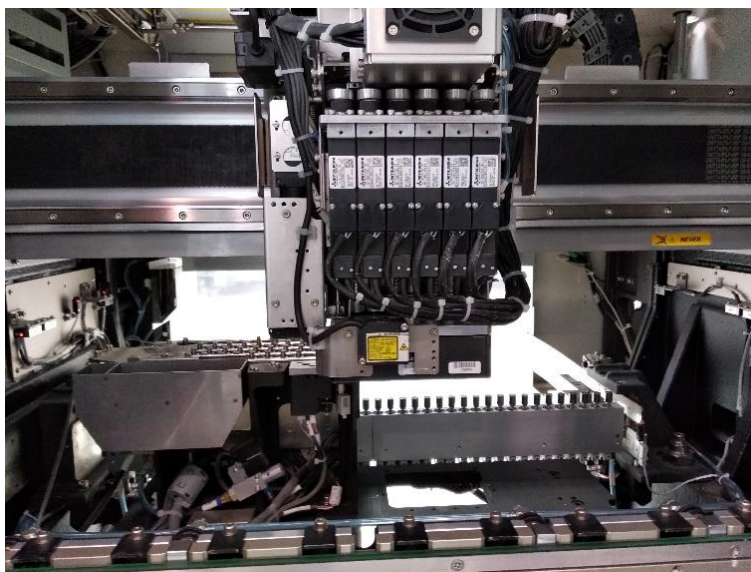
Obr. 9 Hlavice osazovacího automatu [12]
