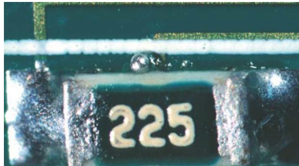
Obr. 31 Kulička vedle součástky [4]
