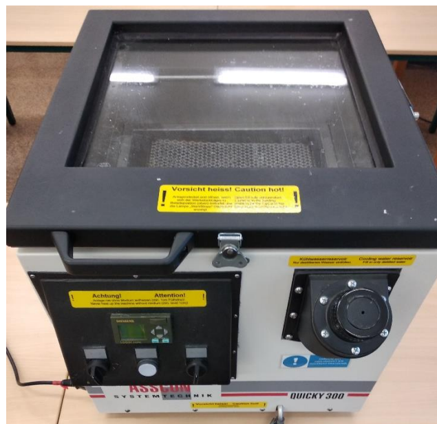
Obr. 15 Pec pro přetavení kondenzací par [13]
