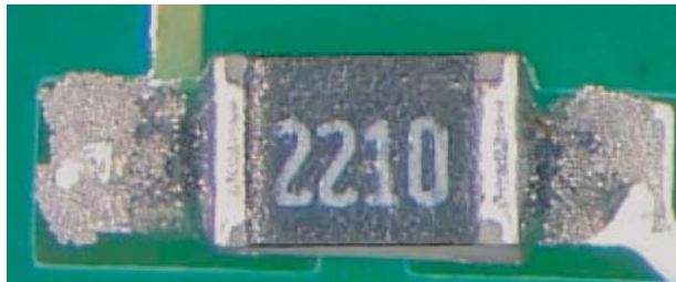
Obr. 29 Nedostatečné přetavení pájecí pasty [4]
