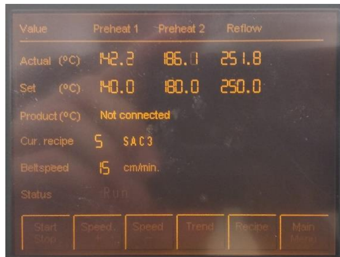
Obr. 40 Teplotní profil přetavovací pece [13]
